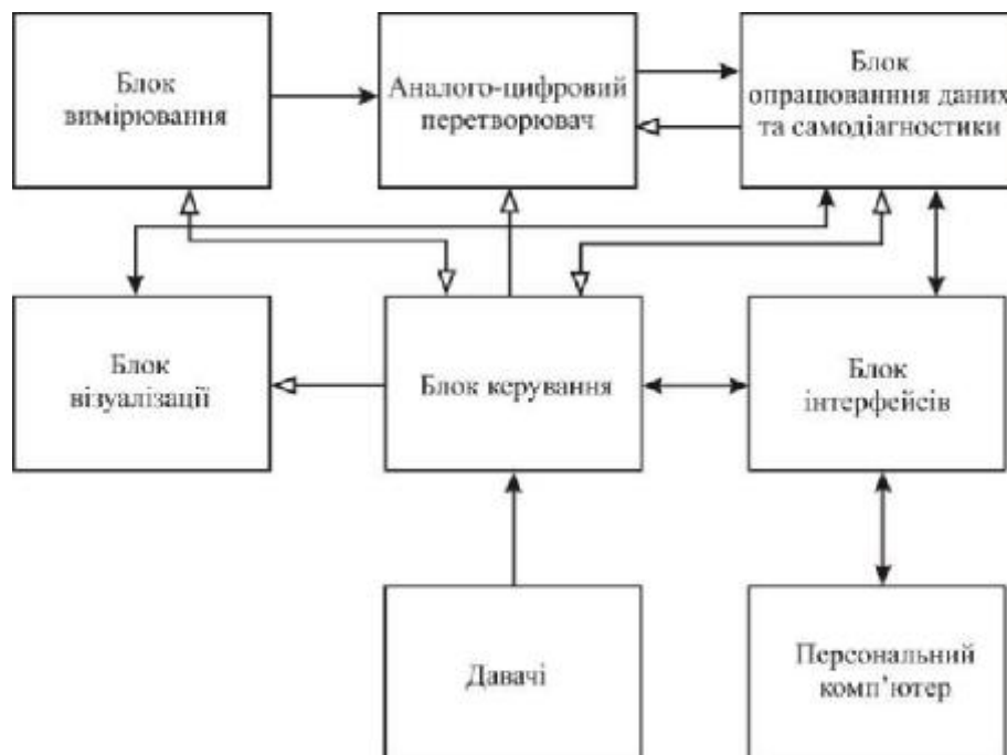
Рисунок. 1 – Структурна схема спеціалізованої програмно-апаратного системи для дослідження термоелектричних властивостей.
