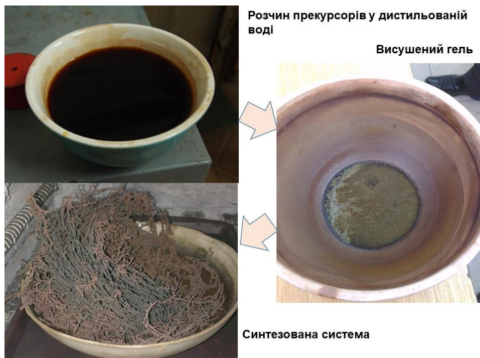
Рис. 7.1. Приготування феритового порошку літій-залізної шпінелі методом золь-гель автоспалювання
