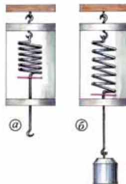
Рис. 116. Градування динамометра: а) нанесення нульової поділки; б) нанесення поділки, яка відповідає дії сили 1 Н
