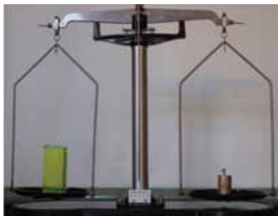
Рис. 97. Дослід підтверджує, що тіла однакової маси, виготовлені з різних речовин, мають різні об'єми
