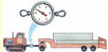
Рис. 121. Вимірювання сили тяги трактора
