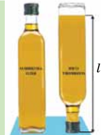
Рис. 54. До експериментального завдання про дослідження рівномірного руху бульбашок повітря в олії
