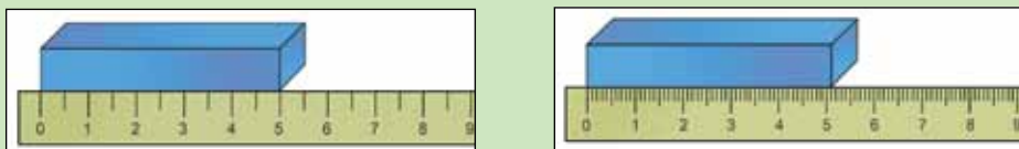
Рис. 12. Вимірювання довжини тіла за допомогою двох лінійок з різною ціною поділки
