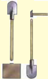
Рис. 90. Два способи насадження лопати на держак
