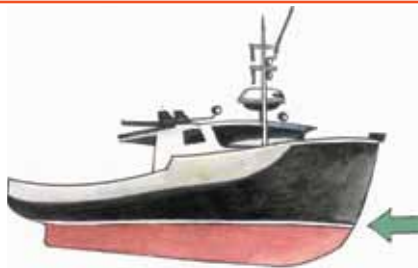
Рис. 196. Найбільш допустима осадка судна — ватерлінія
