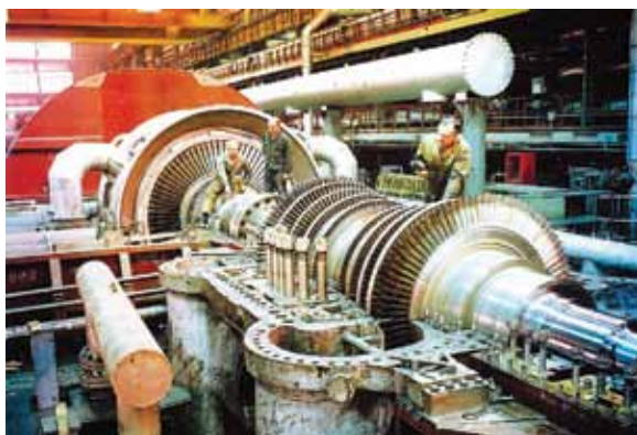
Рис. 226. Монтаж турбіни на заводі «Турбоатом» (м. Харків)
