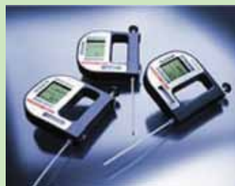
Рис. 100. Сучасні цифрові ареометри (густиноміри)
