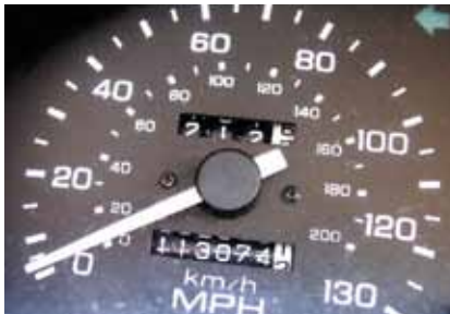
Рис. 48. Автомобільний спідометр та лічильник кілометрів
