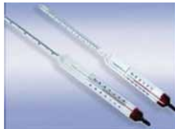
Рис. 99. Ареометр — прилад для вимірювання густин рідин
