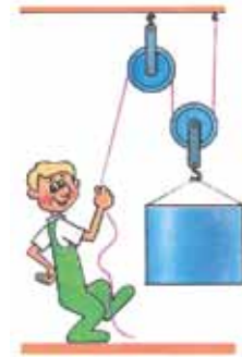
Рис. 220. Система нерухомого і рухомого блоків
