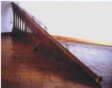
Рис. 79. Дослідна установка, за допомогою якої вивчають скочування кульки вздовж жолоба
