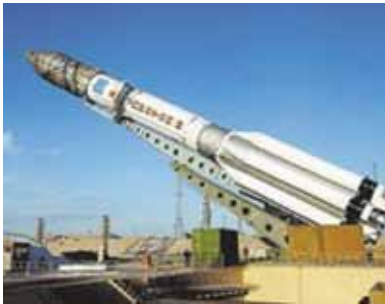
Рис. 133. Форма ракети дозволяє зменшити величину сил опору, які виникають при її русі
