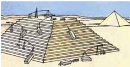
Рис. 209. Використання важелів при спорудженні давньоєгипетських пірамід
