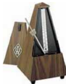
Рис. 46. Метроном — прилад для відліку однакових проміжків часу за ударами молоточка
