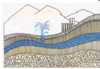
Рис. 164. Система артезіанського колодязя
