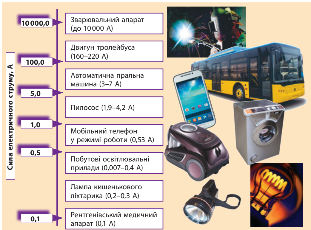
Рис. 27.4. Значення сили струму в деяких електротехнічних пристроях
