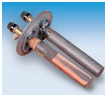
Рис. 37.5. Через кілька хвилин після початку пропускання струму через розчин купрум(II) хлориду поверхню катода вкріє тонкий шар міді
