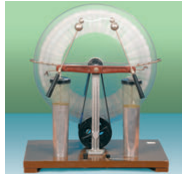
Рис. 40.1. Іскровий розряд між зарядженими кондукторами електрофорної машини
