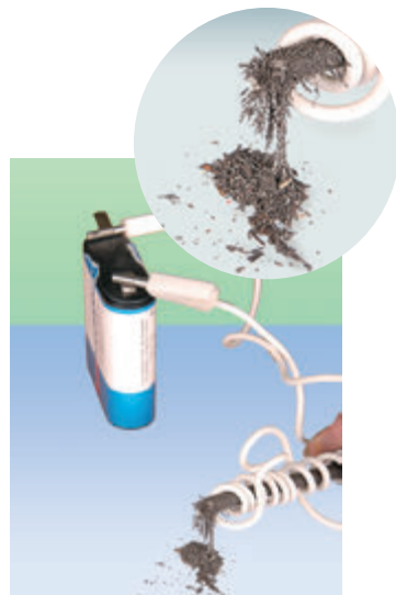
Рис. 24.5. Під час пропускання струму цвях стає магнітом і притягує до себе залізі ошурки
