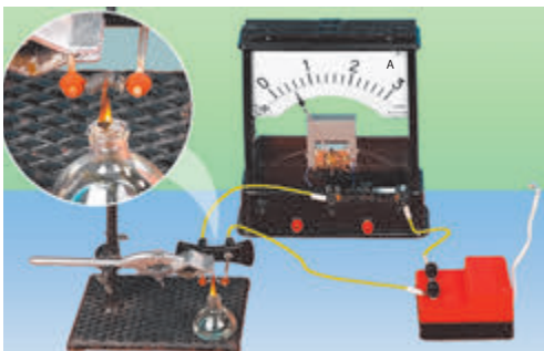
Рис. 36.3. Дослід, що демонструє залежність опору металів від температури. У процесі нагрівання спіралі сила струму в ній зменшується, отже, опір спіралі зростає
