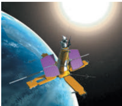
Рис. 25.3. Сонячні батареї супутника дистанційного зондування Землі постачають електроенергію для всієї дослідницької апаратури. Сонячні батареї перетворюють енергію світла на електричну енергію
