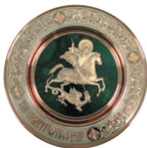
Рис. 38.4. Отримання рельєфних копій за допомогою електролізу: a — схема пристрою: восковий зліпок, покритий тонким шаром графіту, є катодом (1), срібна пластинка — анодом (2); ванна наповнена розчином аргентум(I) нітрату; б — одержана копія
