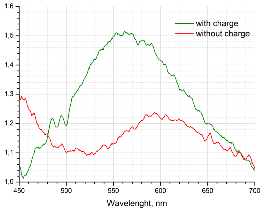
Рисунок 3.8 – Спектри пропускання наночастинок в діелектрику та в діелектрику за наявності заряду
