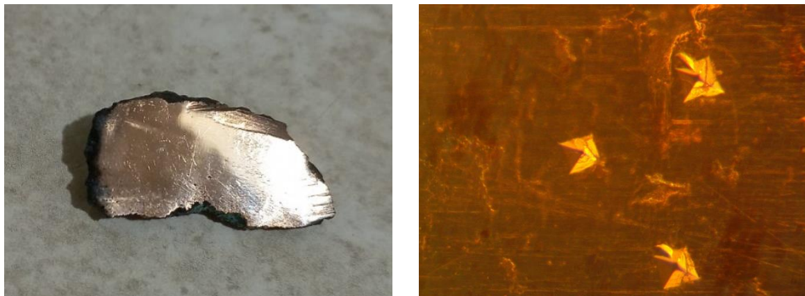
Рис. 2. Загальний вигляд мікрошліфа зрізу оплавка (а) та знімок відбитків піраміди Віккерса, отриманих з використанням мікротвердоміру ПМТ-3 із камерою окуляром UCMOS05100KPA (б)
