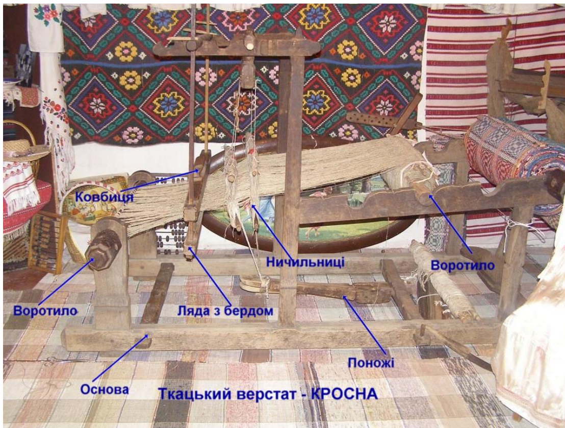
Дод. 3.2.11. Схема ткацького верстата
