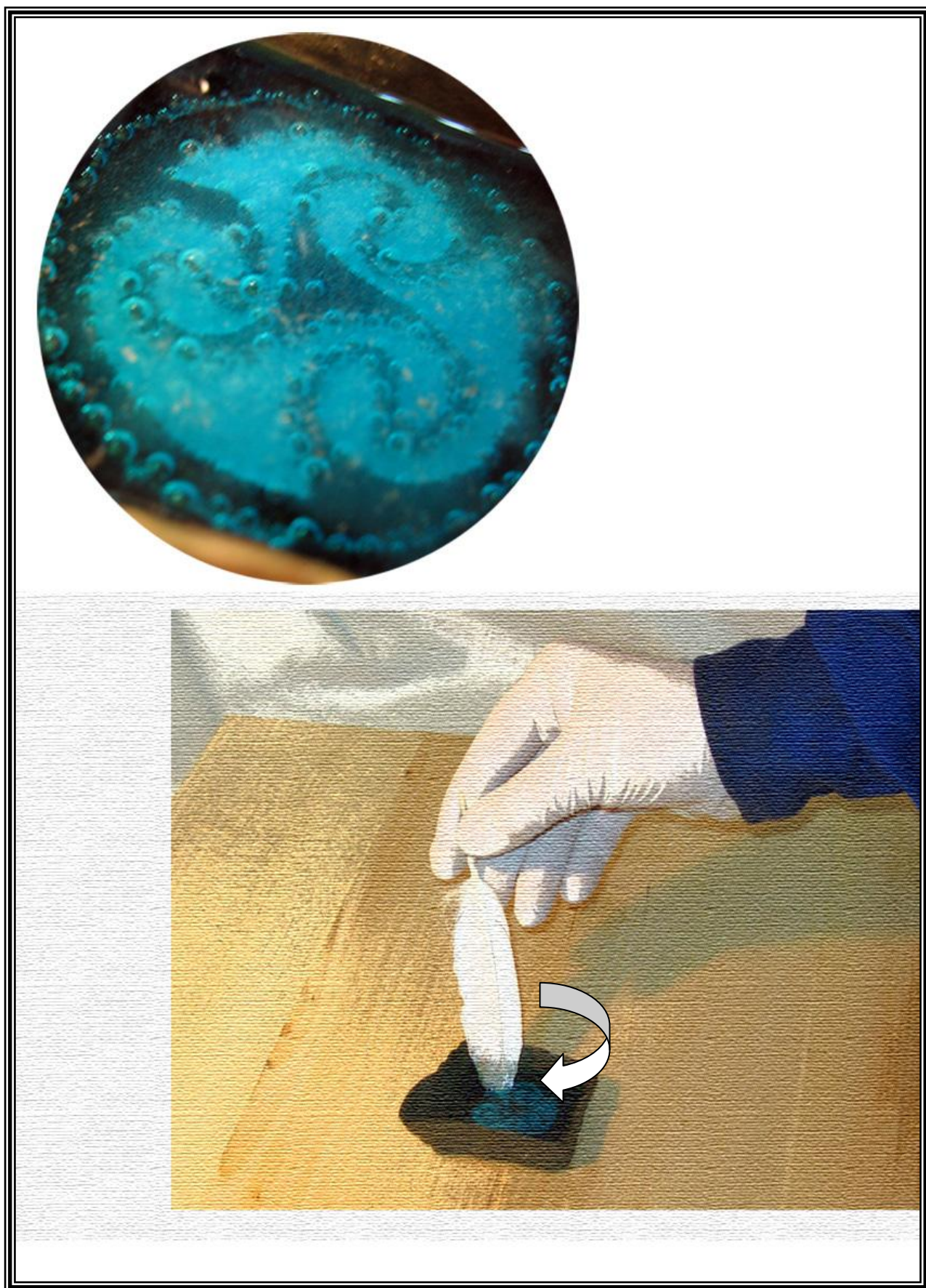
Рис. 44. Процес травлення. Видалення бульбашок газу
