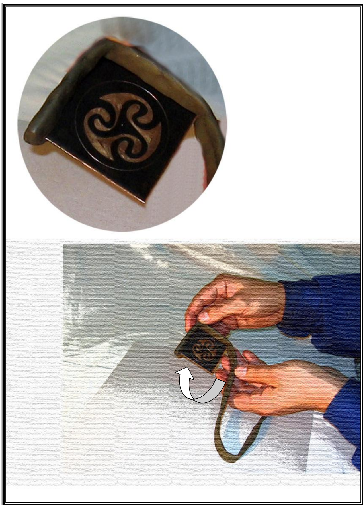
Рис. 40. Підготовка виробу до хімічного травлення
