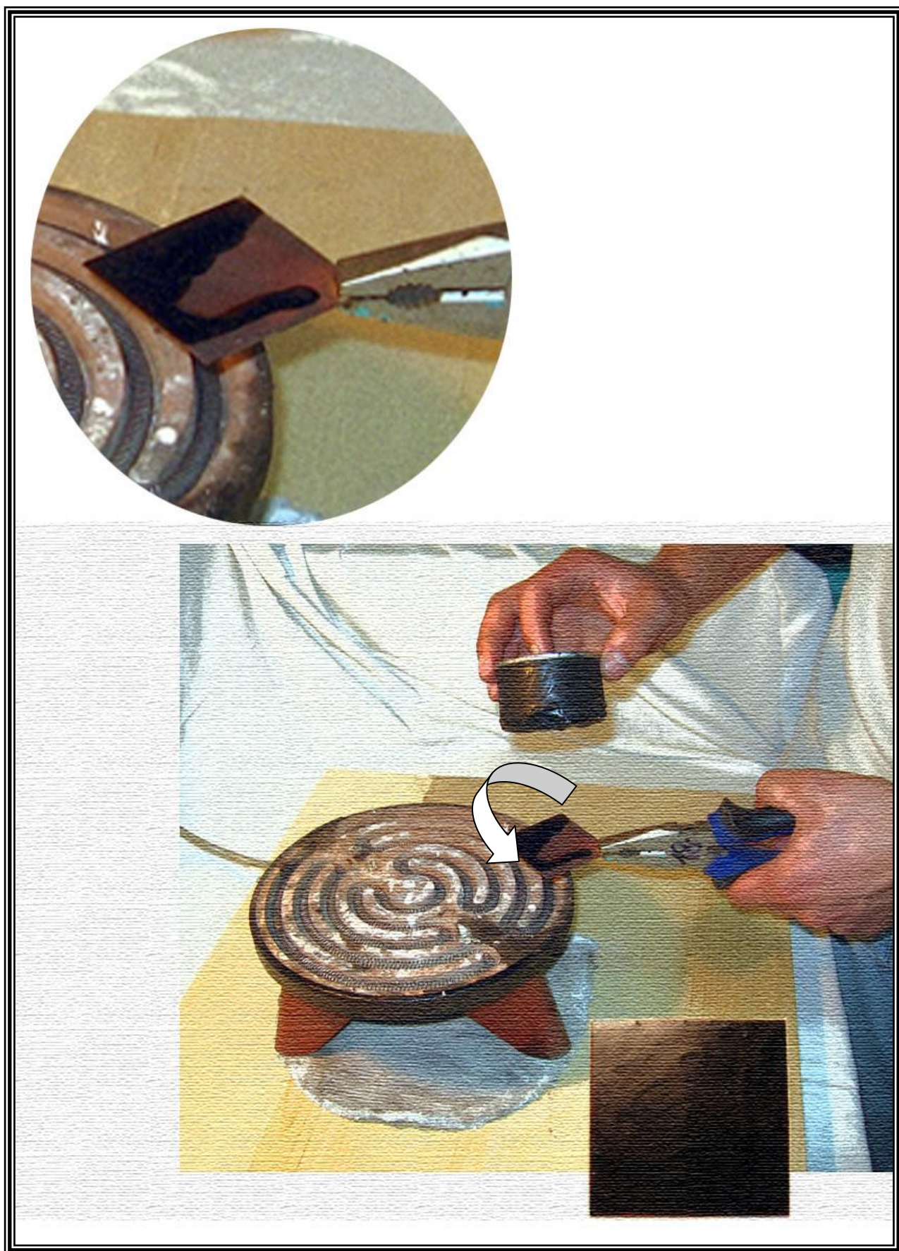
Рис. 31. Покриття заготовки кислотійким розчином
