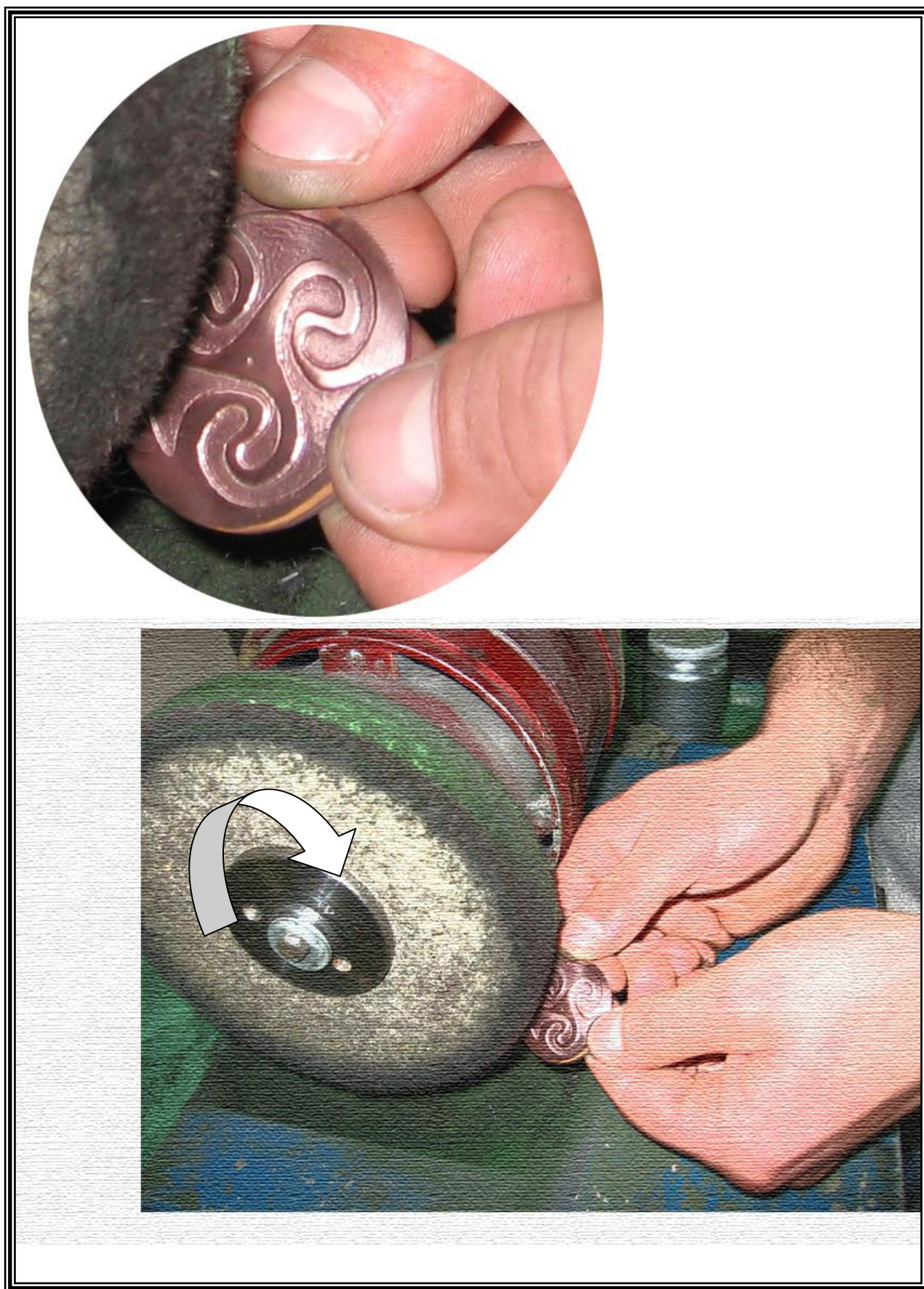
Рис. 50. Поліровка. (правильне утримання заготовки)
