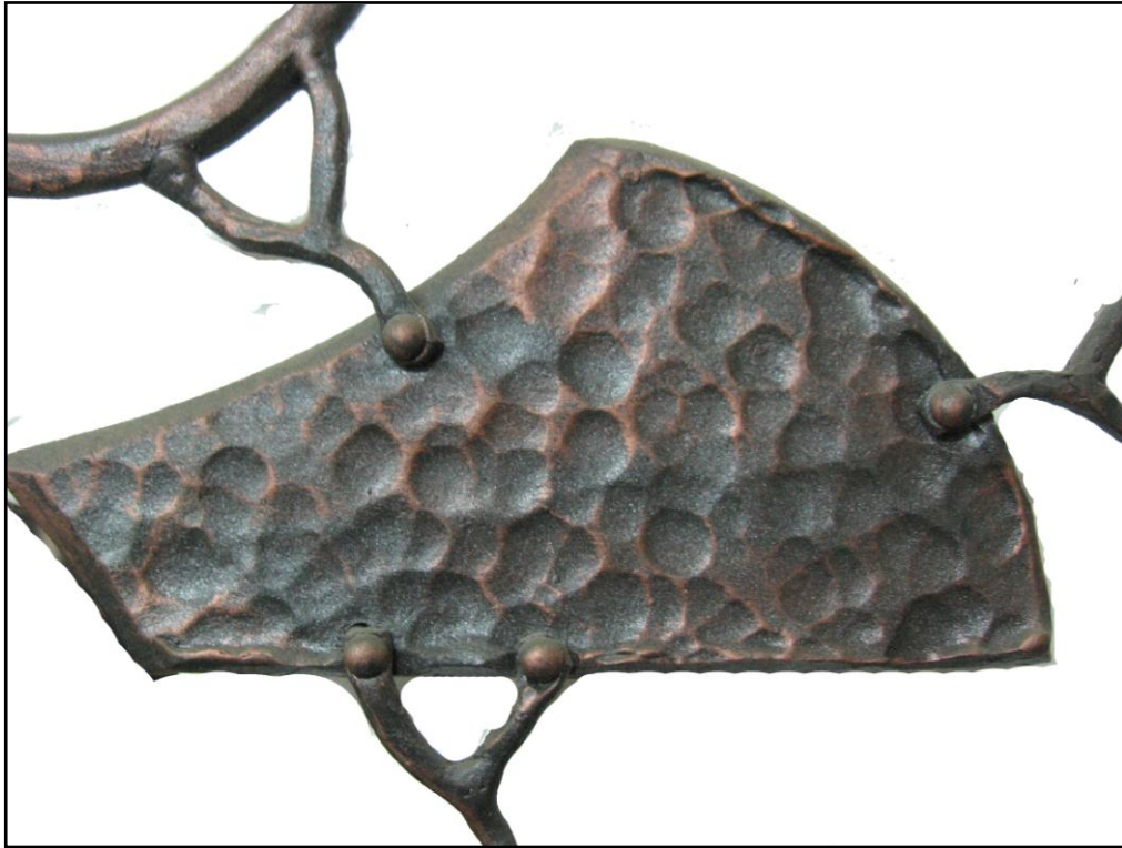
Фото 15. Вивчення основних ковальських прийомів Study of basic blacksmith's receptions (Нанесення фактури, заклепування)
