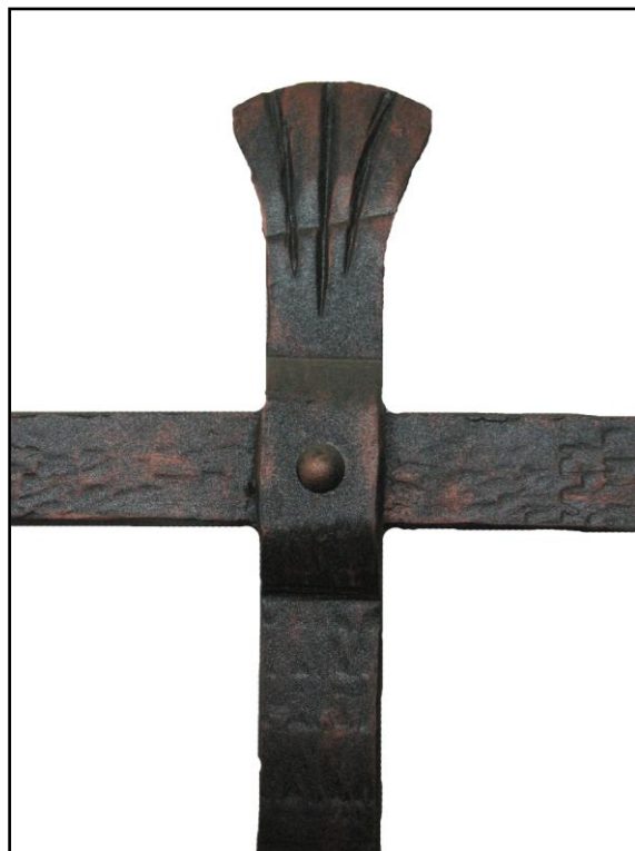
Фото 4. Вивчення основних ковальських прийомів Study of basic blacksmith's receptions (Розклепування, насікання, заклепування, нанесення фактури)
