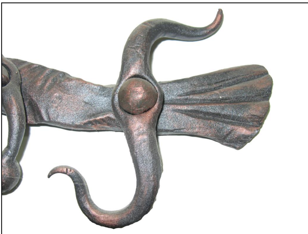
Фото 5. Вивчення основних ковальських прийомів Study of basic blacksmith's receptions (Витягування, насікання, загострювання, заклепування)
