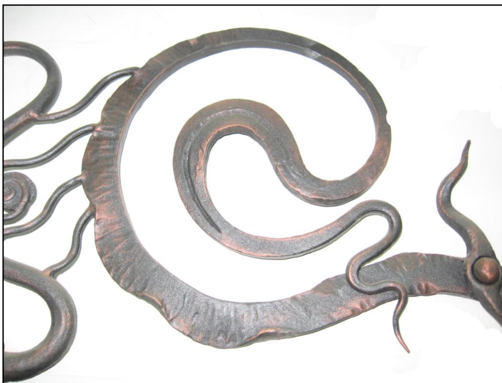
Фото 8. Вивчення основних ковальських прийомів Study of basic blacksmith's receptions (Витягування, насікання, загострювання, закручування, зварювання)
