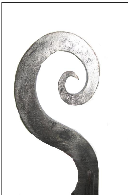
Фото 1. Вивчення основних ковальських прийомів Study of basic blacksmith's receptions (Витягування, загострювання, закручування)
