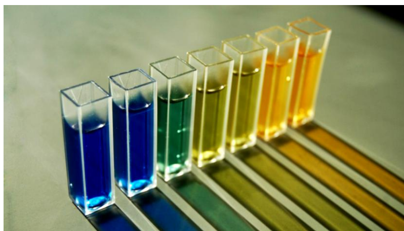
Рис 2. Колір бромкрезолового зеленого у лужному, нейтральному та кислому розчинах (зліва направо відповідно).
