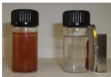
Рис. 6. Фотографія магнітної сепарації ZnFe_2O_4 з водного розчину при дії постійного магніту [7].
