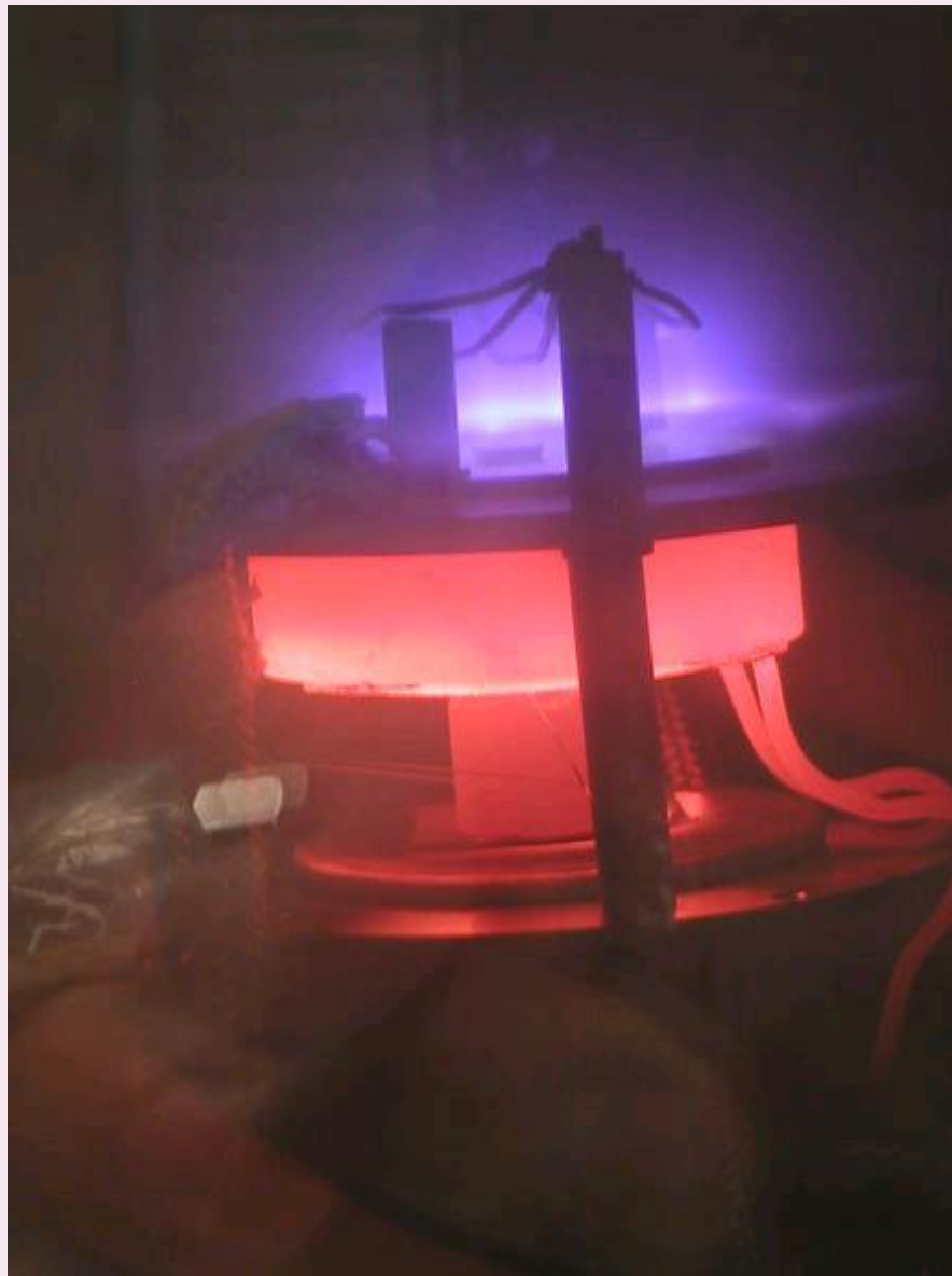
Рисунок 11 Установка PECVD в роботі. Синій ореол у верхній частині установки - світіння плазми.
